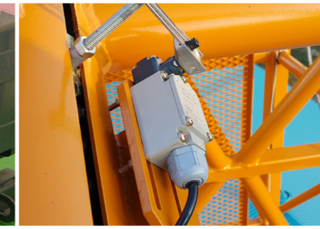
러핑 모션에 대한 전자식 리미트와 캠스위치 리미트의 2중 안전장치 적용
