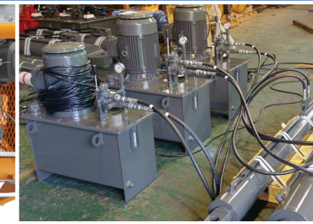
신뢰성 있는 유럽산 부품을 적용한 국산 클라이밍 유압 구동 시스템
